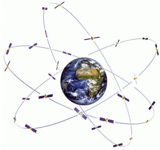
Abbildung 15: Galileo-Konstellation (Quelle: ESA)
