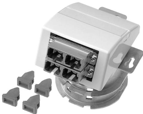
Zwei Teilnehmer können mit Duplex-SC-Steckverbindern angeschlossen werden. Die Dose kann in den Wandkanal in Unterputz- oder geeigneten Aufputzdosen montiert werden. Für Kabel- bzw. Faserreserven ist ausreichend Wickelraum mit kontrollierter Radienbegrenzung vorhanden.
