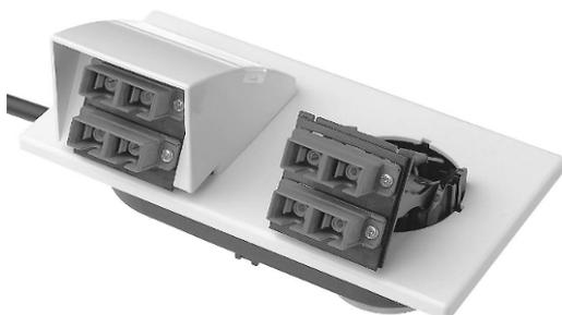
Vier Teilnehmer können mit Duplex-SC-Steckverbindern angeschlossen werden. Die Dose kann in den Wandkanal oder in geeigneten Aufputzdosen montiert werden. Für Faserreserven steht ausreichend Ablageraum zur Verfügung, Spleißablagen sind integriert.
