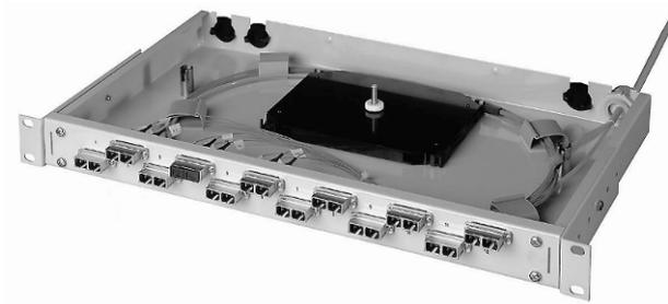
Das Gehäuse erlaubt die Aufnahme von max. 2 Spleiß- oder Kombikassetten. Die Kabeleinführung erfolgt links oder rechts mit Verschraubung ein schließlich Zugentlastungsklemmen und Führungen zur Faser- und Kabelablage.
