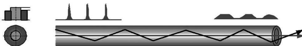
Bild 38: Stufenindexprofil
