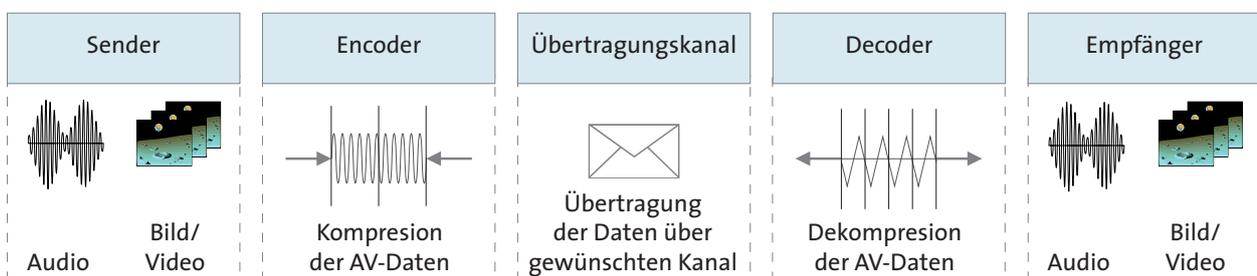
Abb. 5: Vereinfachtes Blockschaltbild eines Codecs „Kodier-Dekodier-System“ zur Übertragung AV-Daten
