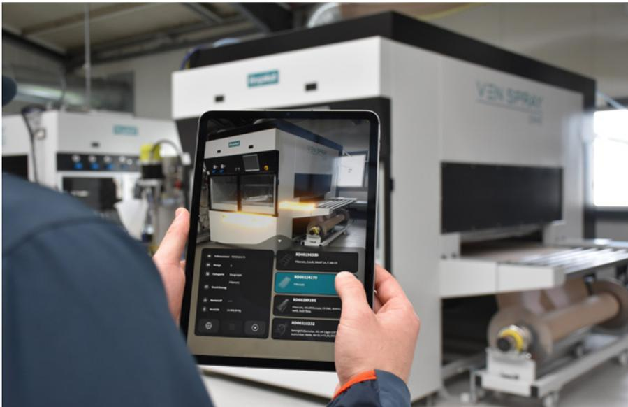
Abbildung 16: Die AR-Anwendung verknüpft Produkt-Metadaten mit den zugehörigen 3D-Modellen und ermöglicht eine präzise Lokalisierung.
