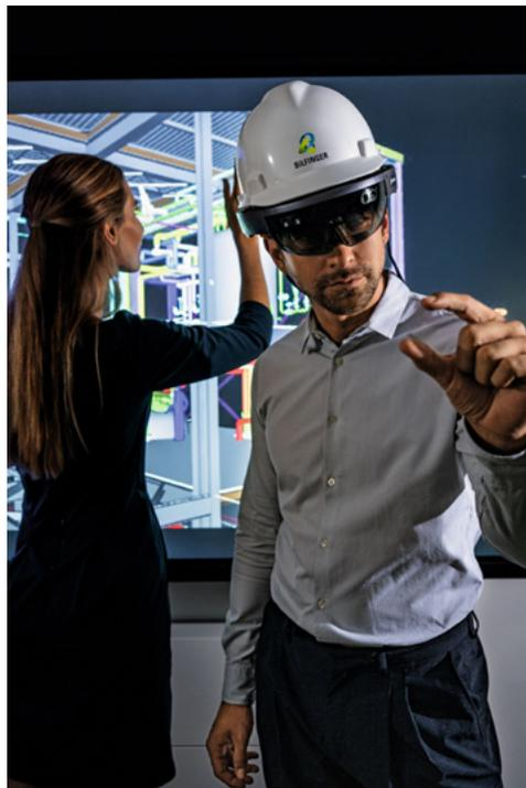
Abbildung 14: 3D-CAD-Modelle lassen sich als Hologramme in Originalgröße visualisieren, mit echten Komponenten verschmelzen und in realer Umgebung bearbeiten (Abbildung: Bilfinger).
