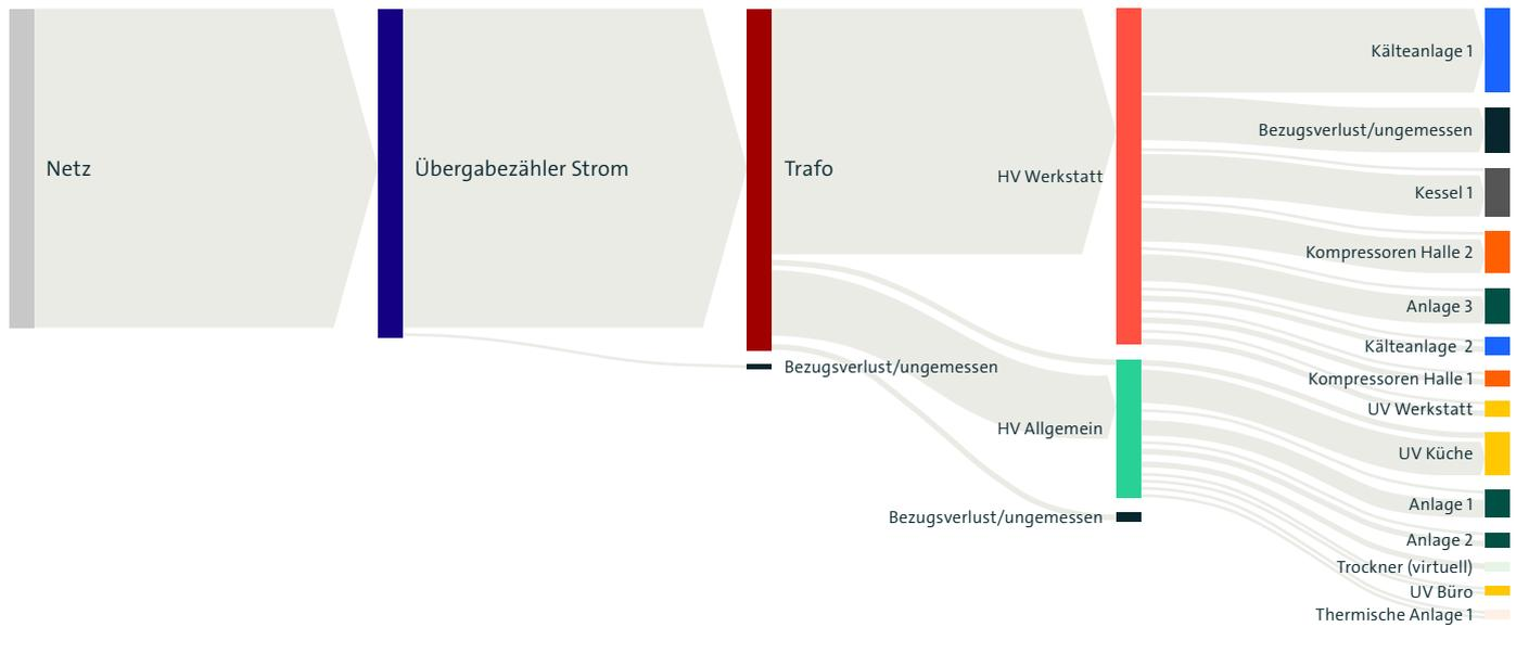
Abbildung 14: Mit dem Sankey-Diagramm energieintensive und damit emissionsintensive Verbraucher erkennen
