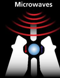
Diese „künstlichen Atome“ werden durch Hinzufügen eines Elektrons in ein kleines Stück reines Silizium hergestellt. Mikrowellen steuern den Quantenzustand des Elektrons.
