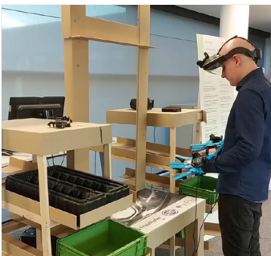
Abbildung 6 – Weiterentwicklung des Mixed Mock-up: Force-Feedback-Handschuhe ermöglichen realitätsnahes Greifen virtueller Bauteile. (Foto: Fraunhofer IEM)
