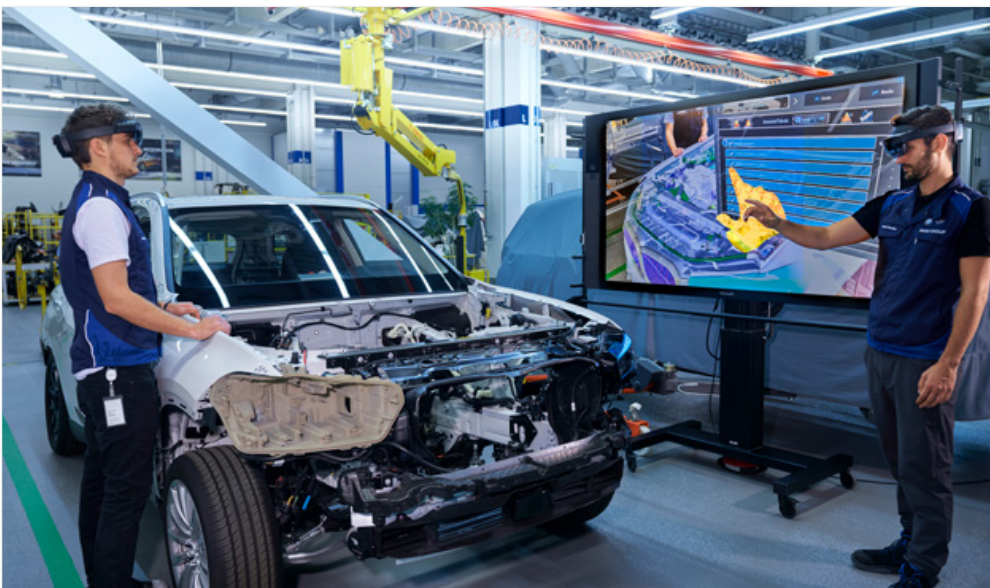
Abbildung 3 – Neue Möglichkeiten für Industriedesigner und Ingenieure: Reale Geometrien lassen sich mit originalgetreuen Hologrammen überlagern. (Foto: BMW Group)
