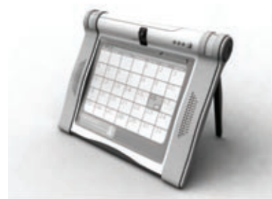
Abb. 15: Modell eines Gate Reminders, damit die Bewohner keine wichtigen Gegenstände mehr zu Hause vergessen [9]
