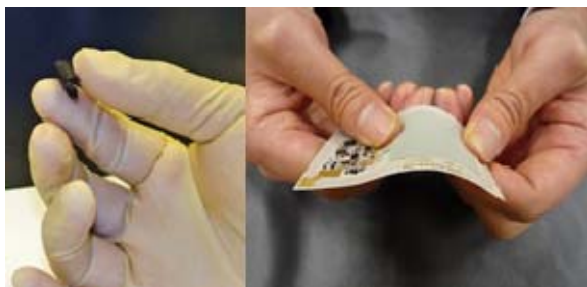
Selbstklebende Technologieentwicklung: Flexible Batterien (Nubion EM4) und EM-Schirme
